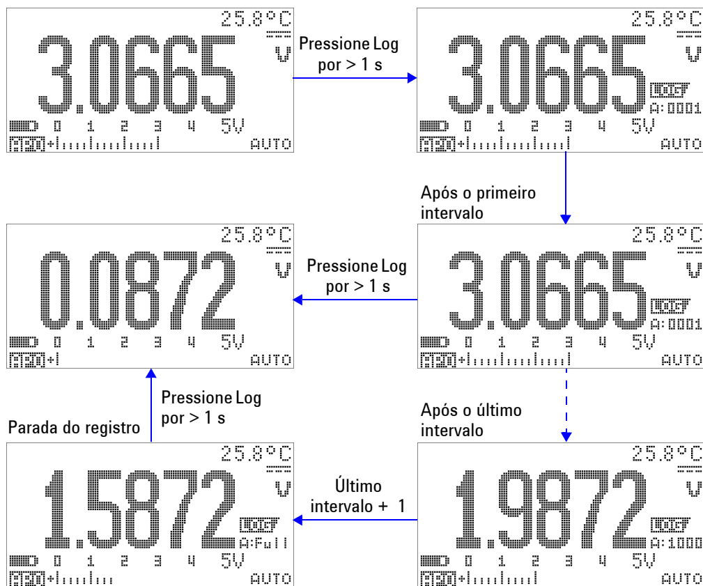
Figura 3-10 Operação do modo de registro em intervalos (time)
